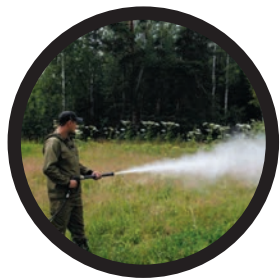
Двухпозиционная форсунка пистолета для формирования компактной и распыленной струи
